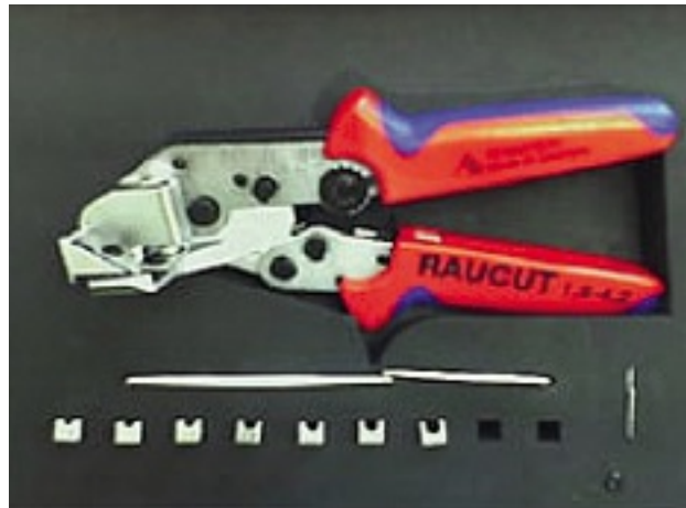
Bild A5-3.4: Beispiel RAUCUT - I Anschnidewerkzeug zum Öffnen von Bündeladernkabeln von 1,8 bis 4,2 mm ohne Fasertrennung.
