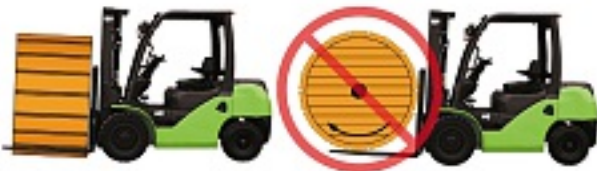
Bild 2-2: Transport von Kabeltrommeln
