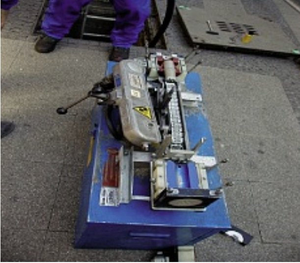
Bild A4-1: SuperJet mit Trapezkette für Speedpipes
