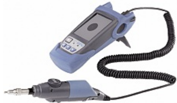
Bild 6-2: Beispiel EXFO FIP-400: LWL-Videomikroskop zur Untersuchung optischer Stecker
