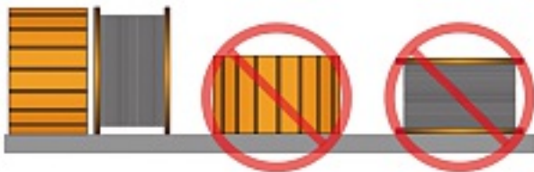
Bild 2-1: Lagerung von Kabeltrommeln
